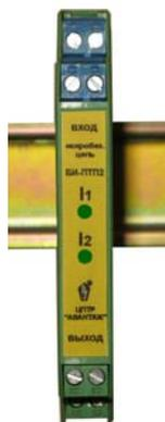
Барьеры искробезопасности пассивные серии БИ-ПТП2 (далее барьер) предназначены для обеспечения искробезопасности по каналу передачи унифицированного сигнала электрических цепей с повторением или разветвлением унифицированных сигналов 4...20мА и гальваническим разделением вход-выход.
